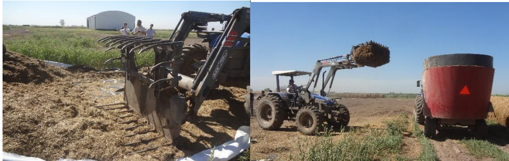
Figura. Aditamento específico para la extracción de silaje acoplado a un cargador frontal.
