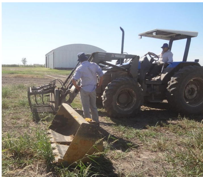
Figura: sistema de acople rápido para cambio de herramienta.
