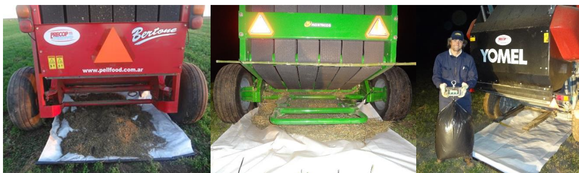
Figura 2: medición de pérdidas en rotoenfardaoras
